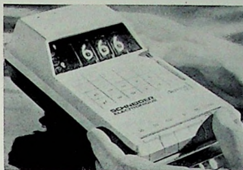
Bild 1. Kleines digitales Vielfachmeßgerät für den Service, das „Digitest 500“ von Schneider
