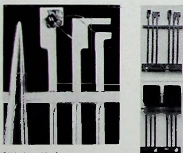
Bild 1. Nach unvergossene Plastiktransistoren von AEG-Telefunken im Vergleich zu einer Nadelspitze (etwa sechsfache Vergrößerung). Das eigentliche Transistorsystem ist auf dem einen Anschlußleiter befestigt und mittels haarfeiner Drähte mit den anderen Anschlußleitern verbunden
